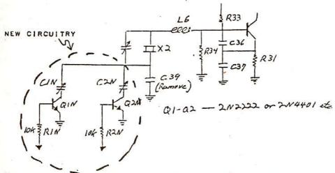
THE IDEA BEHIND THE MODIFICATION IS TO MOVE THE TRANSCEIVERS FREQUENCY DOWN EITHER 5KHZ, 10KHZ OR NOT AT ALL.
